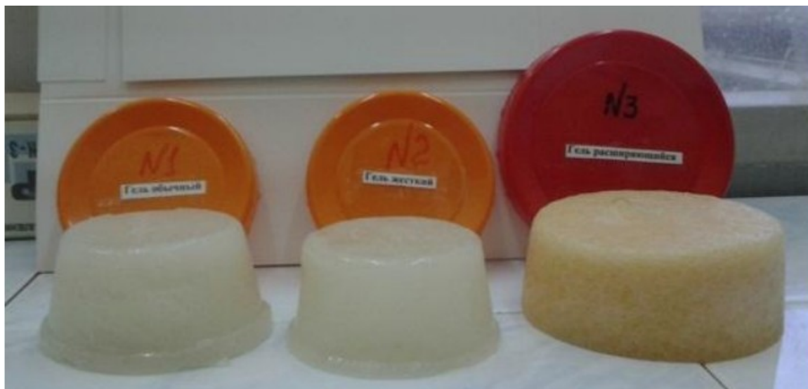
Рисунок 12 - Гелевые системы для очистки труб
